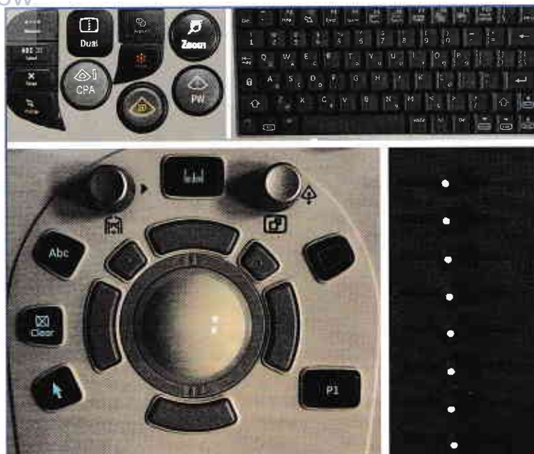
Fig. 1.3. Butoane și taste dispuse la nivelul consolei echipamentului ecografic. Au coduri de imagine standardizate, folosite pentru recunoașterea inițială a funcției aferente. Imaginea prezentată este alcătuită din asocieri de taste, a căror aranjare la nivelul consolei este variabilă în funcție de producător.
